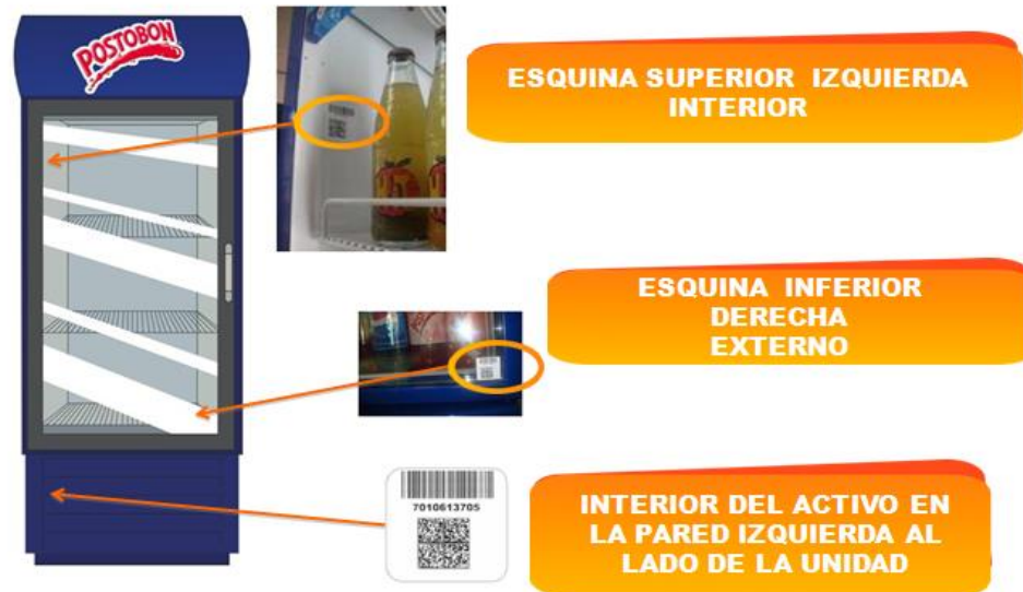
Figura 9. Lugares de instalación de códigos de barras
