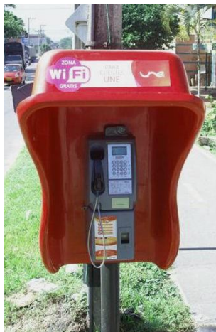
Ilustración 7: Teléfono público existente desde el 2000 hasta la actualidad, prueba piloto con el uso del Wi-Fi.
