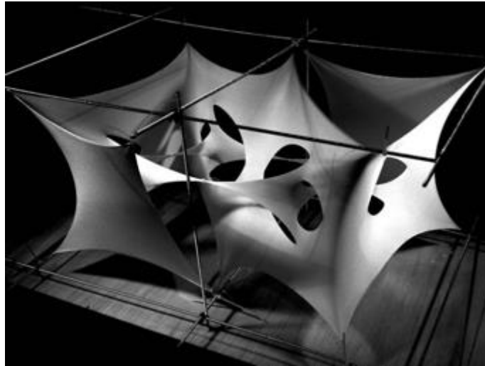
Figura 10: Material flexible tensado en marcos. Membrana flexible de tela tensada en marcos de metal. Tomada del documento Procesos de búsqueda formal para objetos industriales. Mesa Pulgarín, Vélez Marín, Londoño, & Montoya Vega. P. 36.
