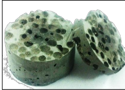
Figura 3. Resultado sinterización de polvos metálicos y rellenos removibles.
