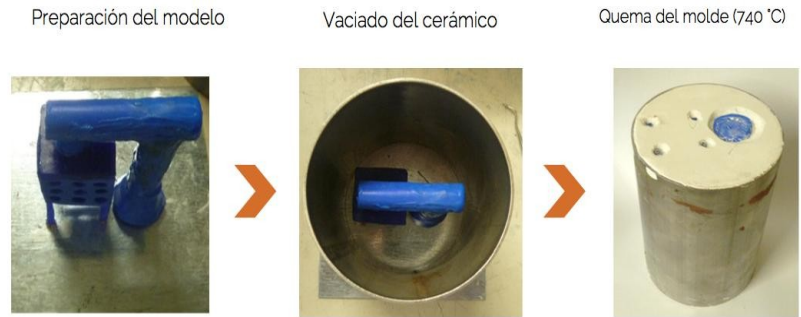
Figura 7. Elaboración molde cerámico
