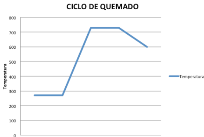
Figura 15 . Gráfica ciclo de quemado. Tiempo vs Temperatura
