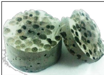
**Figura 3. Resultado sinterización de polvos metálicos y rellenos removibles.**
