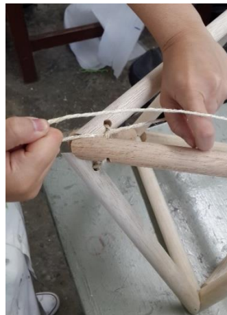
Figura 21. Unión de los listones que generan la estructura por medio de cabuya.
