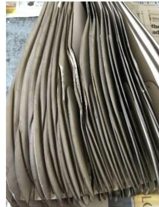
l. estado final de la estructura después del ensayo de compresión.
