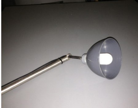
Figura 10. Sensor de humedad y temperatura Cámara de maduración.
