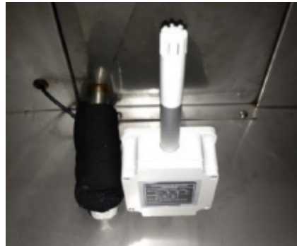
Figura 28. Sensor de humedad y temperatura.
