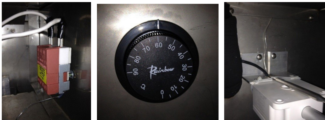
Figura 2. Ubicación y configuración del termostato en la Cámara de ambiente controlado.
