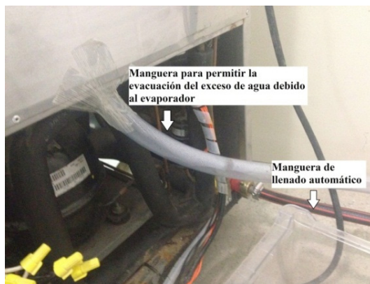
Figura 1. Conexión de mangueras para llenado automático y para permitir la evacuación del exceso de agua.
