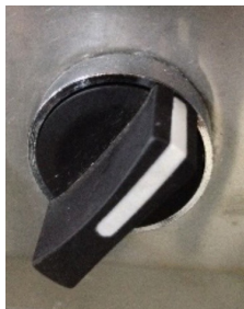
Figura 4. Interruptor selector de tipo muletilla de dos posiciones.
