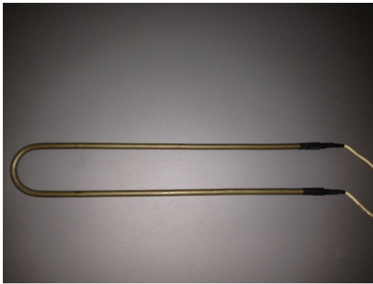
Figura 30. Resistencia eléctrica por aire forzado de 1500 W.
