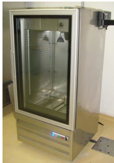
Figura 2. Cámara de maduración para productos cárnicos existente. Reproducida con permiso de Isaza (2012).
