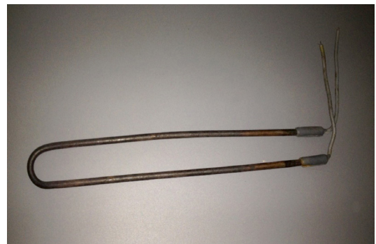
Figura 15. Resistencia eléctrica por aire forzado de 310 W.
