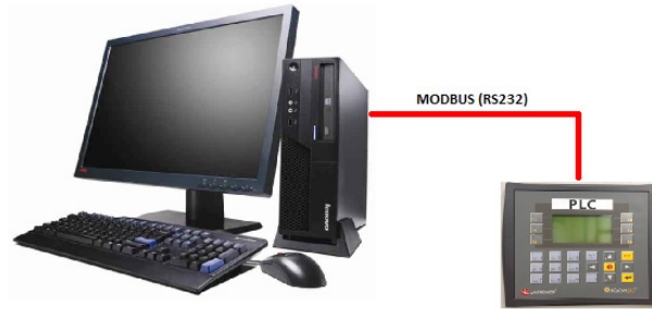
Figura 77. Funcionamiento Modbus PC (Maestro) - PLC (Esclavo).
