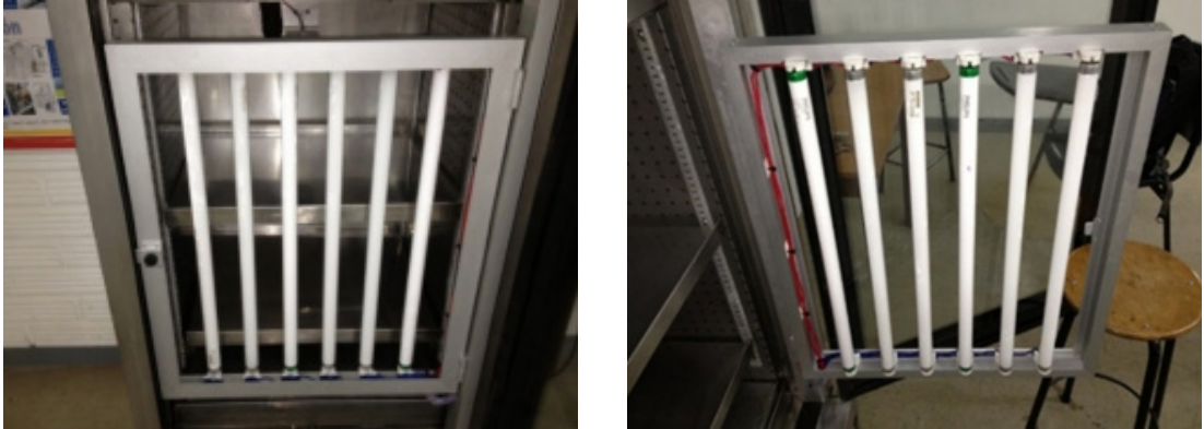
Figura 29. Instalación de tubos fluorescentes.
