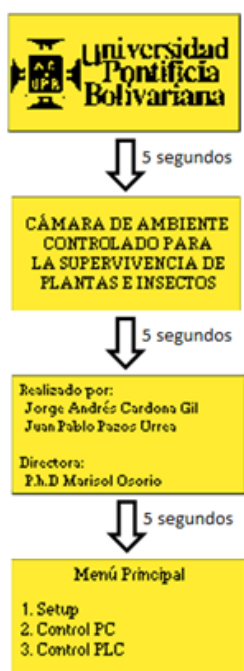
Figura 3. Secuencia mostrada en la pantalla del PLC al momento de encenderlo.
