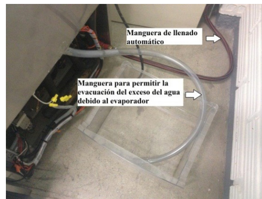
Figura 1. Conexión de mangueras para llenado automático y para permitir la evacuación del exceso de agua.
