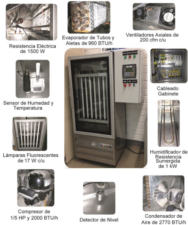
Figura 37. Cámara de ambiente controlado.
