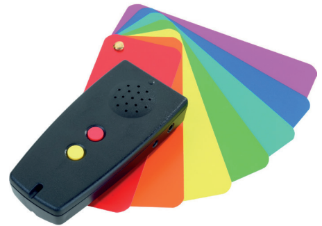
Figura 28. Colorino, es un reconocedor de colores y luz diseñado para personas ciegas.
