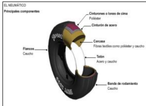
Ilustración 2. Componentes de una llanta
