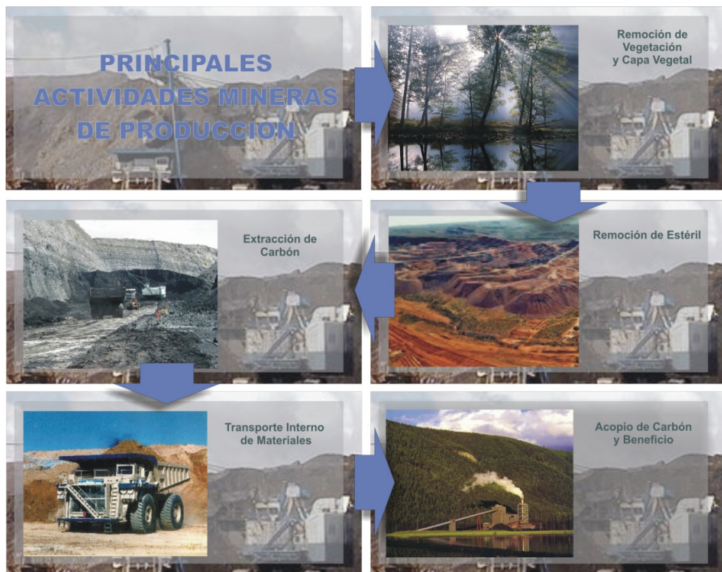
Figura 3. Principales etapas de producción de carbón a cielo abierto.
