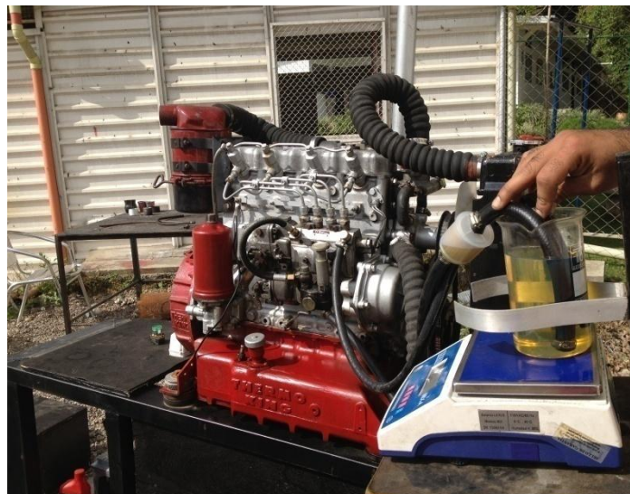
Figura 14. Prueba de consumo de combustible a un régimen determinado de revoluciones
