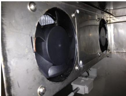
Figura 20. Ventiladores vista externa
