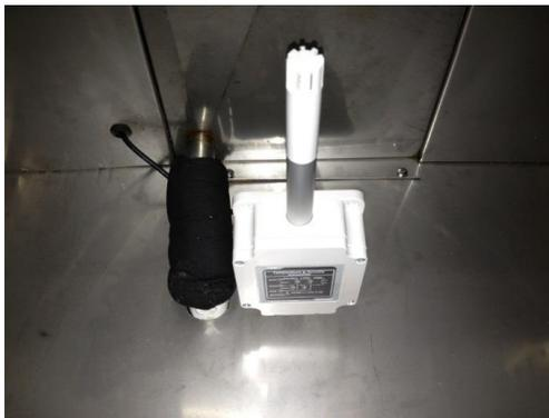
Figura 28. Sensor de humedad y temperatura
