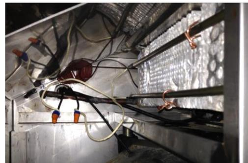
Figura 31. Resistencia eléctrica por aire forzado de 1500 W en la Cámara de Ambiente Controlado
