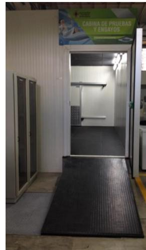
Figura 21. Cámaras climáticas modulares tipo *Walk-in*
