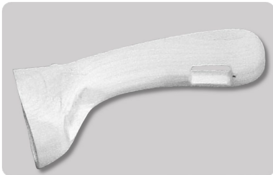
Figura 43 Modelo 3D del mango del cuerpo en poliestireno
