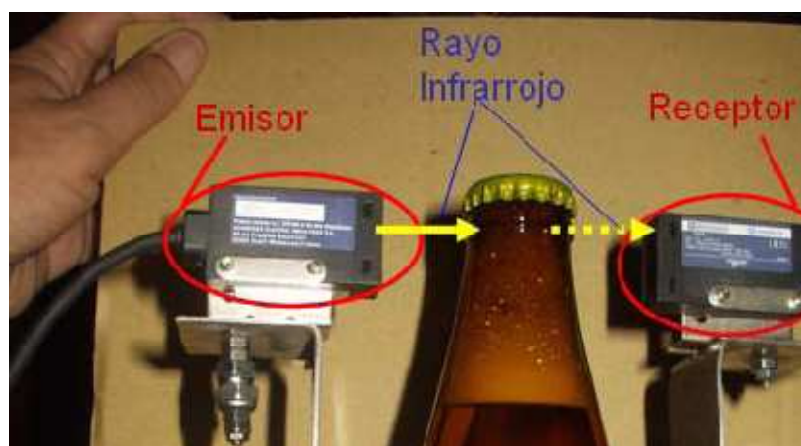
Figura 47. Montaje para sincronización del sensor XUM-W
