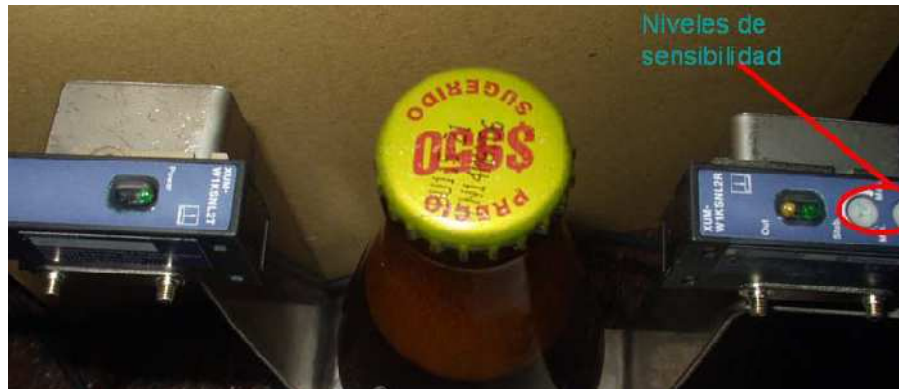
Figura 48. Potenciómetros usados para el cambio de sensibilidad
