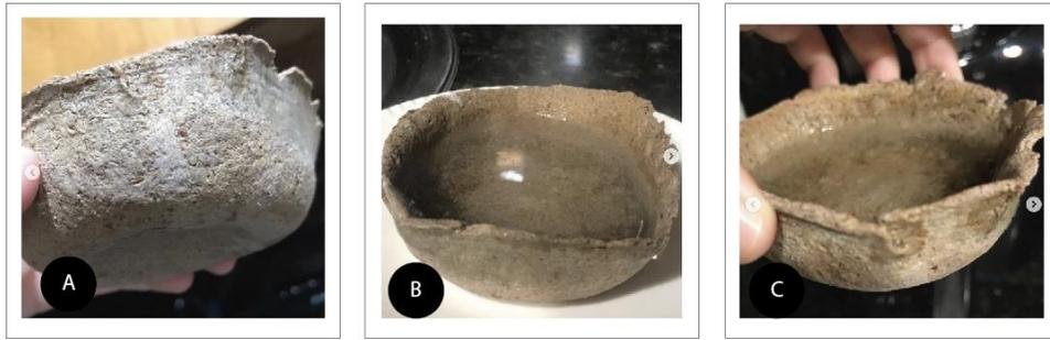
*Galería 2 Probetas expuestas al contacto directo con el agua caliente 50°C*
