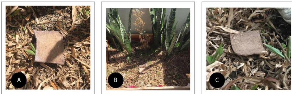
*Galería 4 Muestra de lamina 5x5 en prueba de degradación, lamina c en proceso de 4 semanas.*
