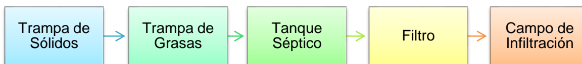
Figura No. 13. Unidades de tratamiento del STARD.
