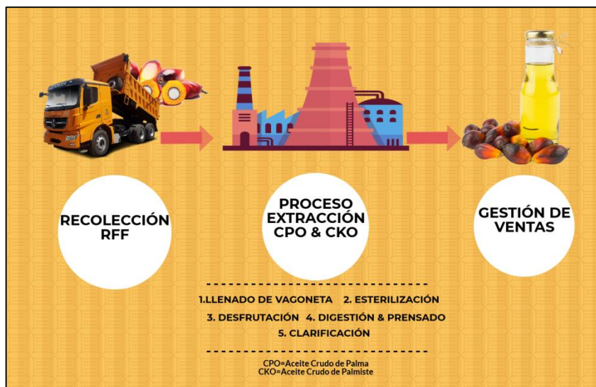
Figura No. 2. Proceso de producción Planta de Beneficio.
