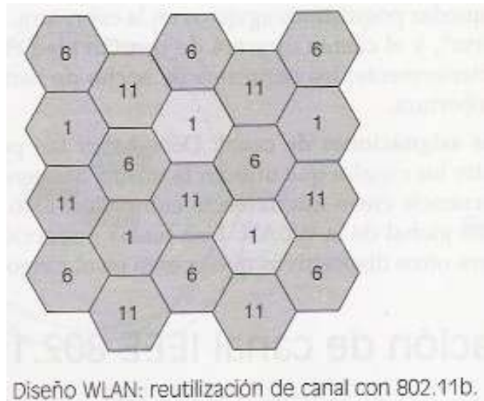
Figura 3. WLAN: Reutilización del canal con 802.11b y 802.11g
