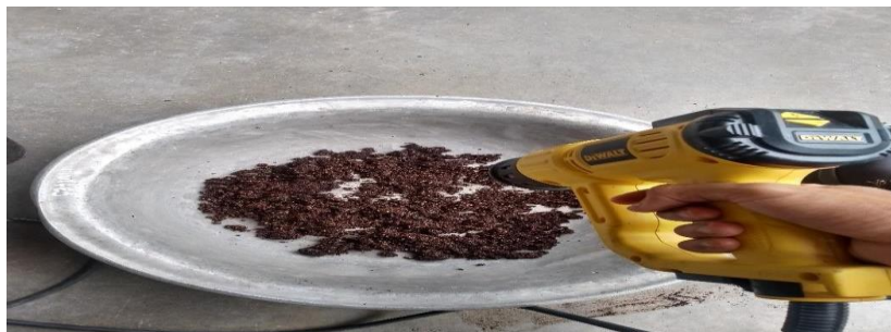
Imagen 9. Material siendo secado por la pistola de calor
