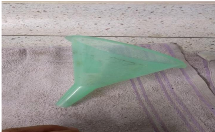
Imagen 11. Embudo usado para agregar el material dentro del picnómetro
