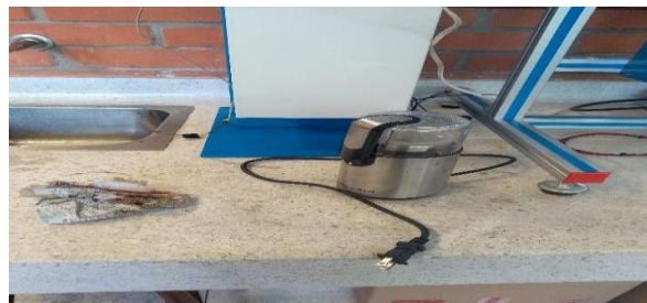
Imagen 4. Molino de cuchillas eléctrico usado para moler la materia prima
