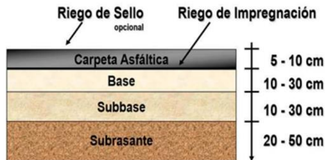
figura 2. Corte transversal del pavimento flexible.
