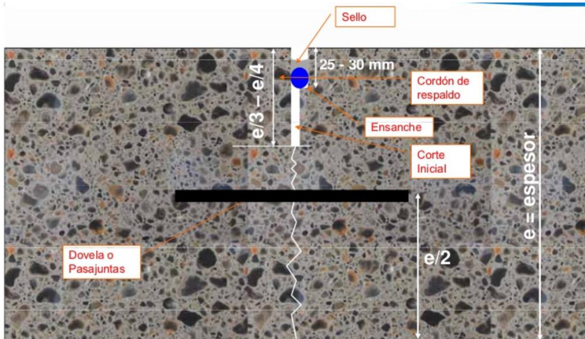
figura 13. Corte de una junta.
