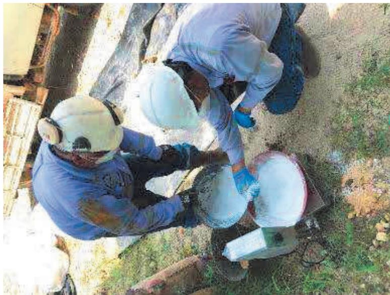
*Ilustración 4.* Pesaje de Cal hidratada para la preparación de las muestras de sedimentos con hidrocarburos, material de afirmado y cal hidratada
