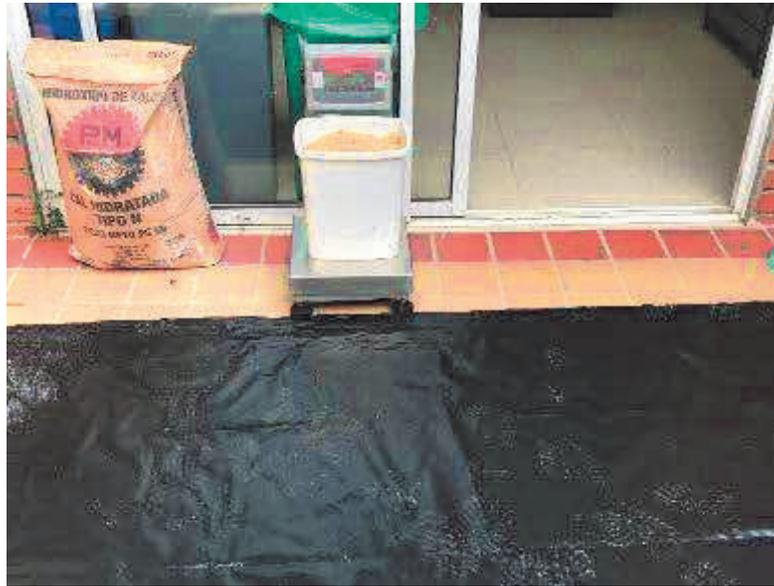
*Ilustración 3.* Balanza y Cal hidratada para la preparación de muestras de sedimentos con hidrocarburos, material de afirmado y cal hidratada
