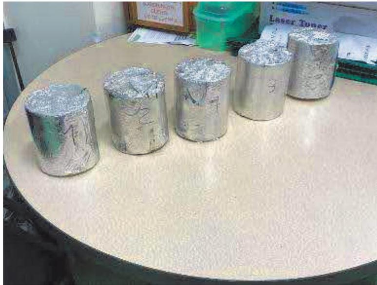
*Ilustración 8. Muestras de sedimentos con hidrocarburos, material de afirmado y cal hidratada compactadas con la humedad óptima para los análisis fisicoquímicos*
