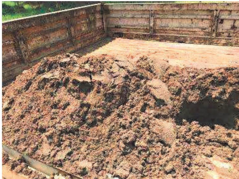
*Ilustración 2. Sedimento con contenido de hidrocarburo proveniente del contrapozo LS M11 de Campo Salinas en PetroSantander (Colombia) GmbH*
