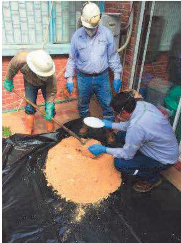
*Ilustración 5.* Material de afirmado empleado para la preparación de las muestras
