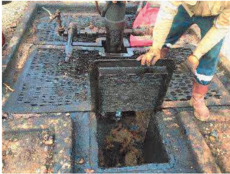
*Ilustración 1. Sedimento con hidrocarburo almacenado en el contrapozo LS M11 en Campo Salinas de PetroSantander (Colombia) GmbH*
