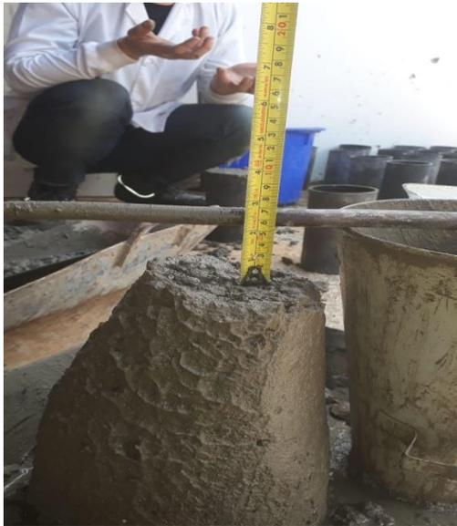
*Ilustración 22: Asentamiento 0% RCD (Testigos de Concreto). Fuente: Elaboración Propia.*
