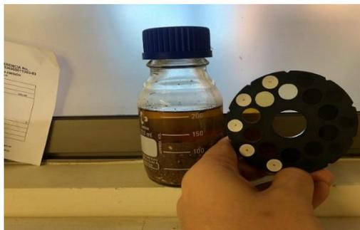
*Ilustración 31: Ensayo de Impurezas Inorgánicas del Agregado Fino RCD. Fuente: Elaboración Propia.*
