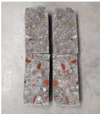
*Ilustración 30: Resultado de la Tracción Indirecta de los Especímenes de Concreto. Fuente: Elaboración Propia.*
