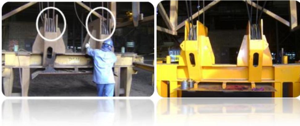
**Fig. 47. Cambio de cable, poleas del yugo de la grúa. Fuente: Autor**
