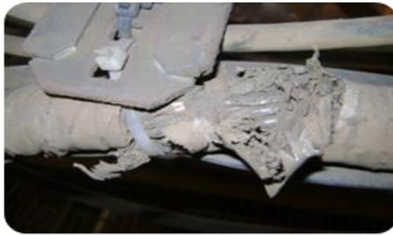
**Fig. 49. cable festón en mal estado. Fuente: Autor**
