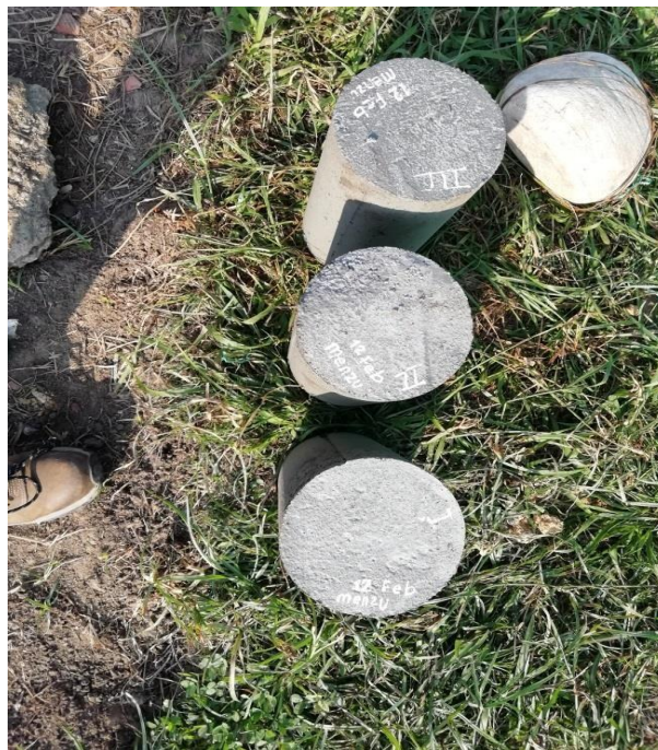
Fotografía 18. Cilindros para ensayos de resistencia a la compresión
