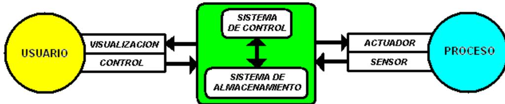
**Figura 37.** Estructura Básica de un Sistema de Supervisión y Mando. [1][3]
