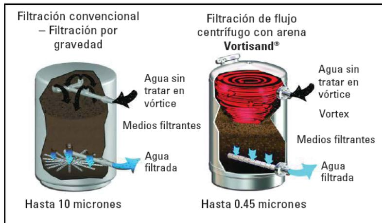
**Figura 12.** Filtro Multimedia Vs. Sistema Vortisand. [18]
