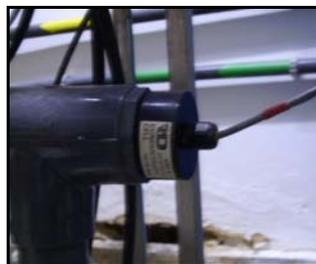
**Figura 22.** Sondas de Conductividad y Temperatura de Entrada. [1]
