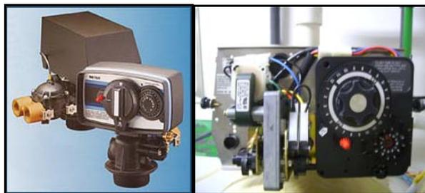
**Figura 17.** Sistema de Reloj Electromecánico. [1][13]
