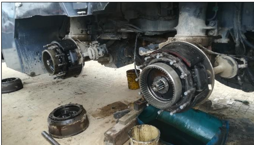
Figura 28. Desmontaje de servo transmisión de Krupp 3055 Fuente: Autor
