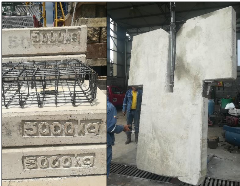
Figura 7: Contrapesas y lastres de torre grúa. Fuente: Autor.
