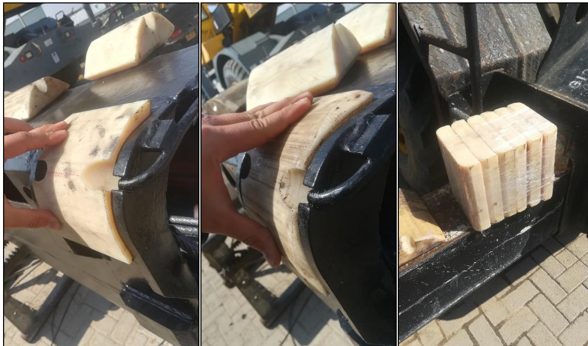
Figura 30. Deslizadores nuevos instalados Fuente: Autor.
