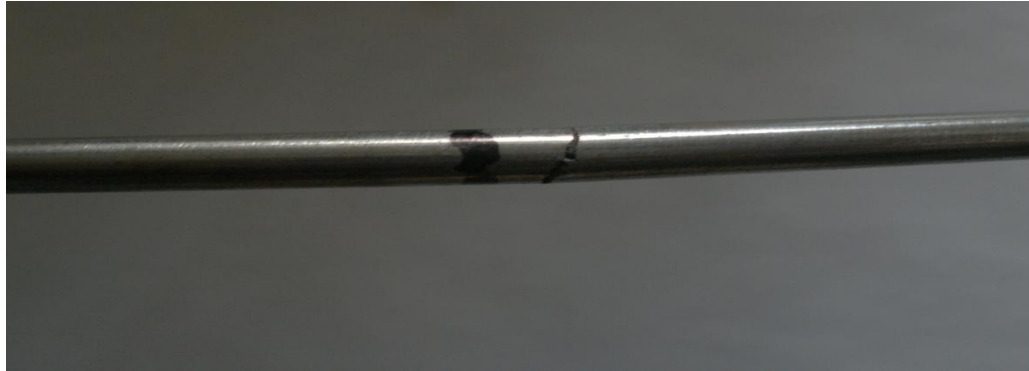
Figura 35: Propagación de la grieta causada por fatiga
