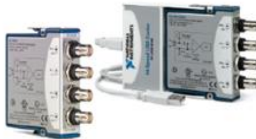
Figura 16: foto de la tarjeta de adquisición NI 9233 con la cual se realizaron las pruebas.
