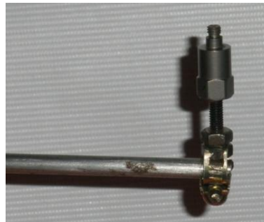
Figura 24: Posicion del acelerometro en el extremo de la probeta.
