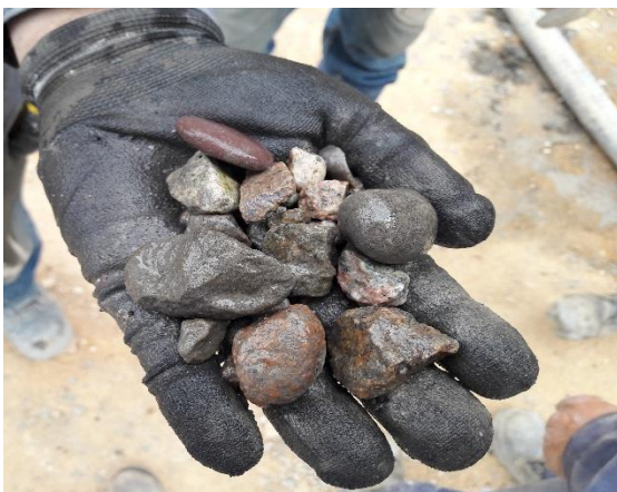
Imagen 36. Adherencia nula o deficiente de material por uso de aditivo no apto para el lanzado
