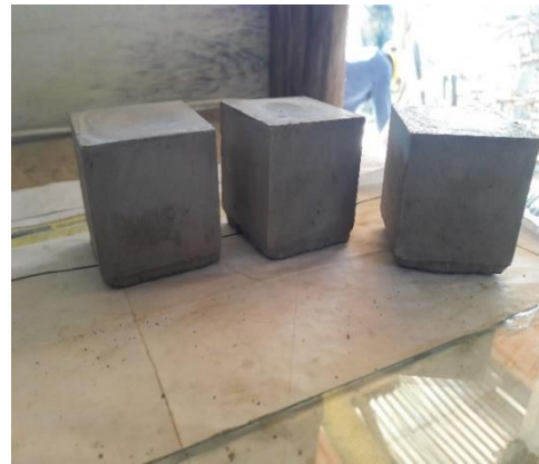
Imagen 25. Cubos de lechada resist. esperada 4500 psi
