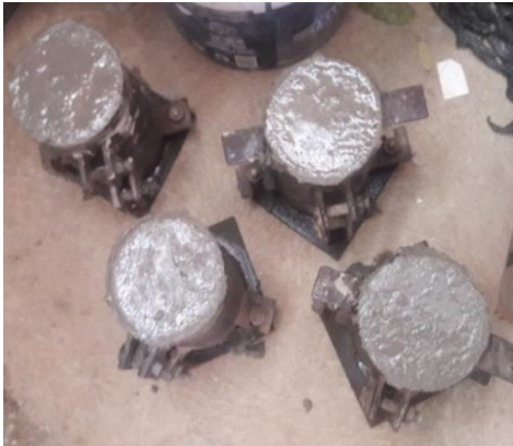
Imagen 24. Toma de muestras de cilindros, dados en concreto
