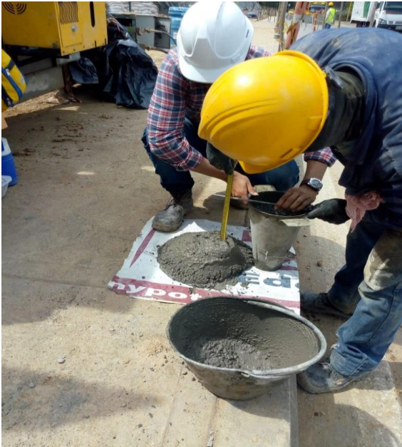
Imagen 28. Medición asentamiento para concreto lanzado
