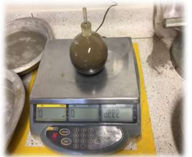
Peso del picnómetro + agua + muestra Fuente: Autor.
