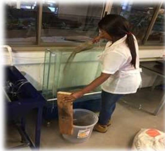
Inicio del llenado del modelo con suelo Granular.
