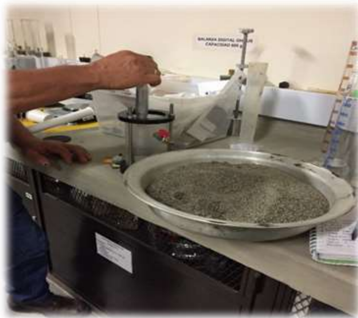
Compactación de arena; 35 golpes por capa. Fuente: Autor.
