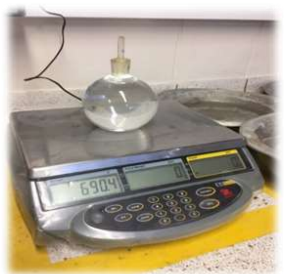
Peso del picnómetro + agua. Fuente: Autor.
