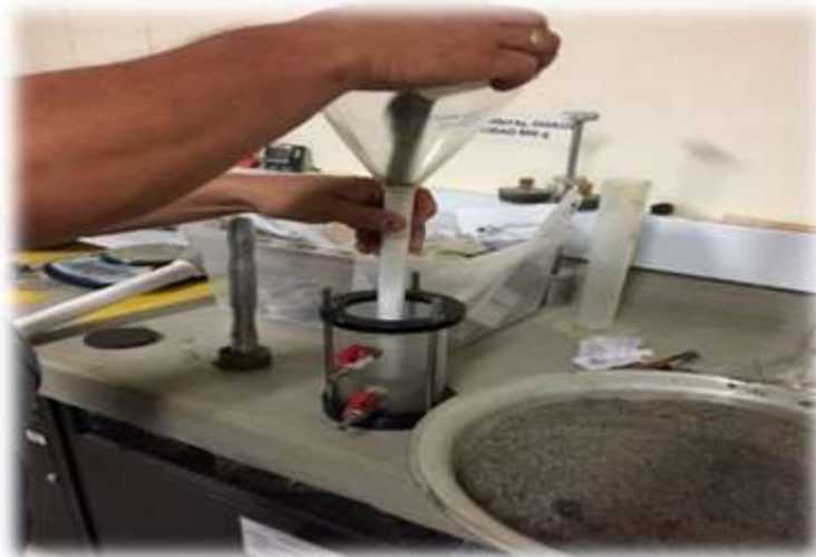
Inclusión de la muestra al permeámetro.
