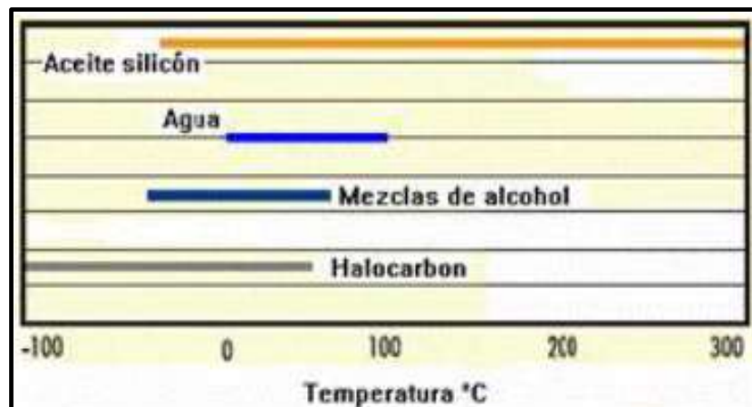
Gráfica 36. Rango de temperatura de los líquidos utilizados en los baños líquidos. 40
