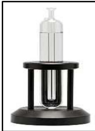
Gráfica 35. Punto triple del agua para realizar calibraciones. 39
