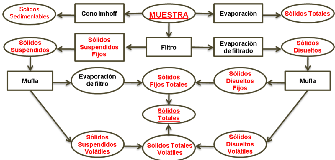
Figura 1. Interrelación de las fracciones de sólidos presentes en las aguas residuales
