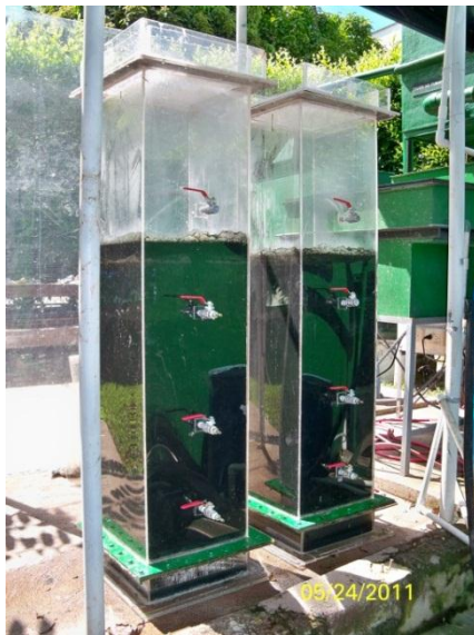
Figura 11. Lodo sembrado en los reactores UASB
