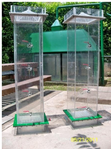
Figura 10. Reactores UASB a escala laboratorio acoplados
