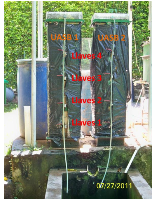
Figura 14. Perfil de llaves acondicionadas en los reactores
