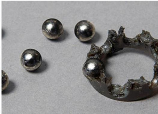
Figura 1. Daño en rodamiento causado por el desgaste.
