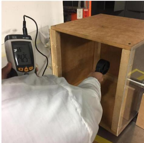
Figura 26. Medición de la velocidad de salida de la boquilla
