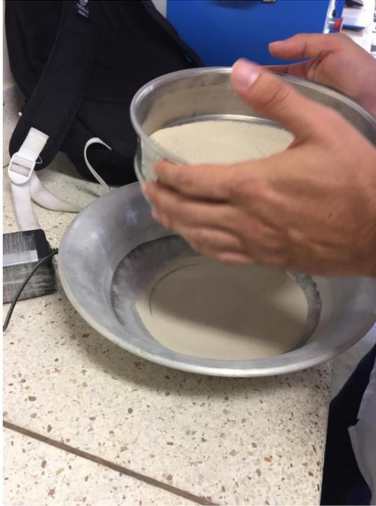
Figure 27. Tamizaje de arena en tamaño de  $200\ \mu\text{m}$ .
