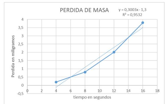
Figura 30. Perfil de desgaste erosivo para las probetas en función del tiempo
