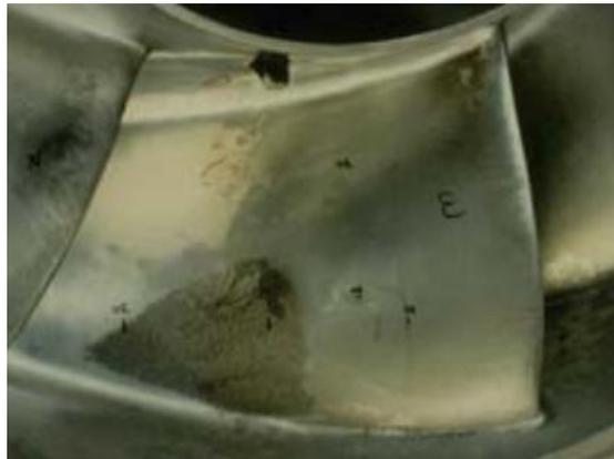
Figura 9. Álabes de una turbina afectado por la cavitación
