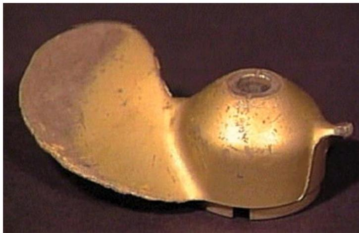
Figura 8. Hélice desgastada por erosión
