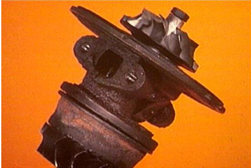
Figura 5. Turbocompresor oxidado debido a altas temperaturas.
