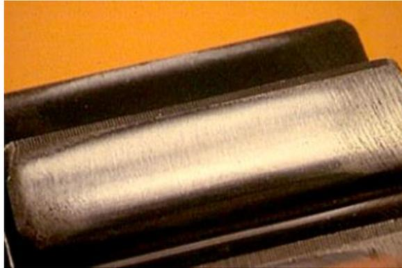
Figura 4. Superficie satinada por causa de partículas abrasivas.
