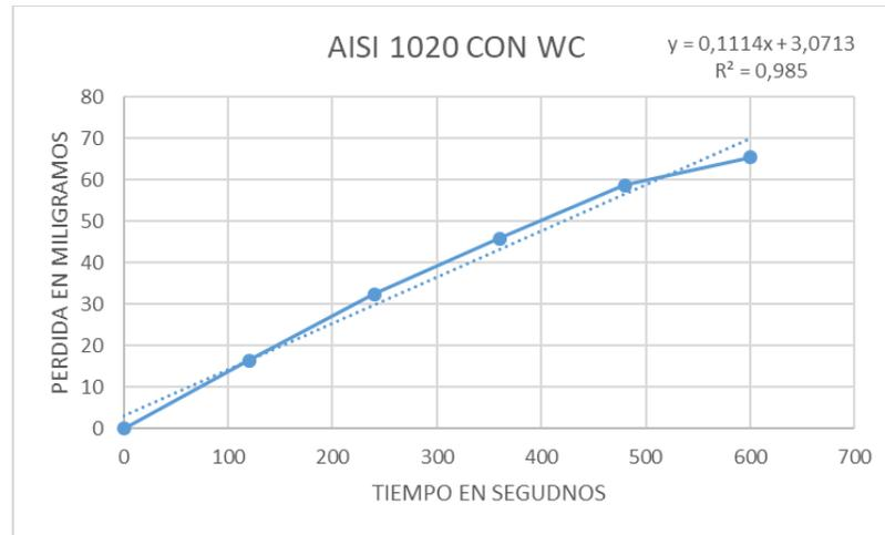
Figura 32. Perfil de desgaste erosivo para las probetas con recubrimiento en función del tiempo.
