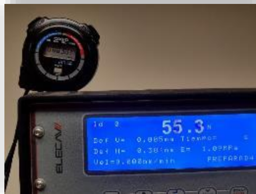
Ensayos de corte directo consolidado drenado
