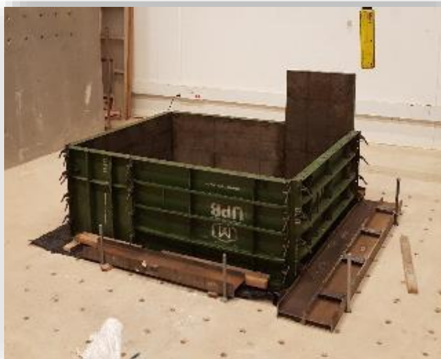
Modulación para cajón de suelo de fundación
