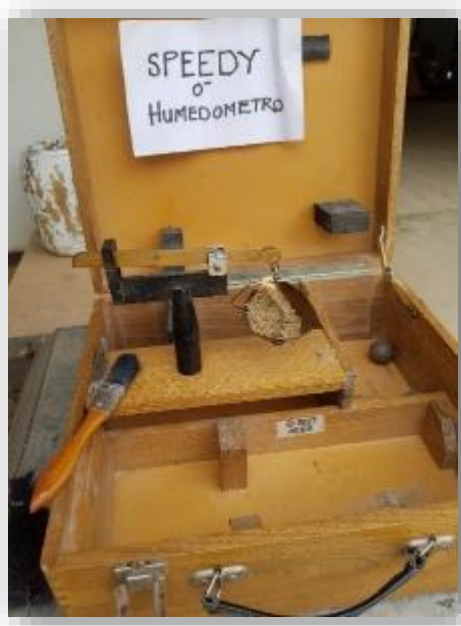
Speedy para humedad del material
