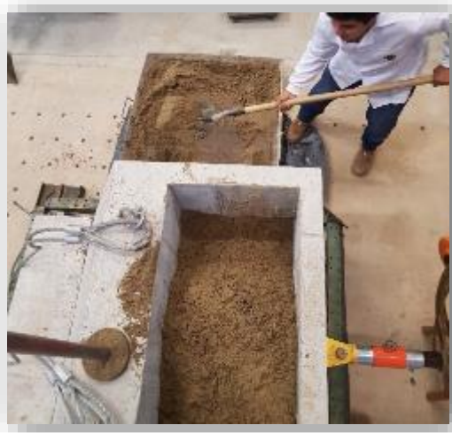
Relleno y compactación de relleno activo
