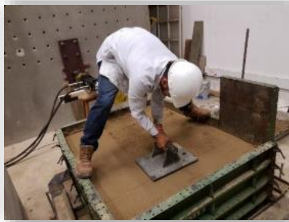
Compacción por capas de suelo de fundación
