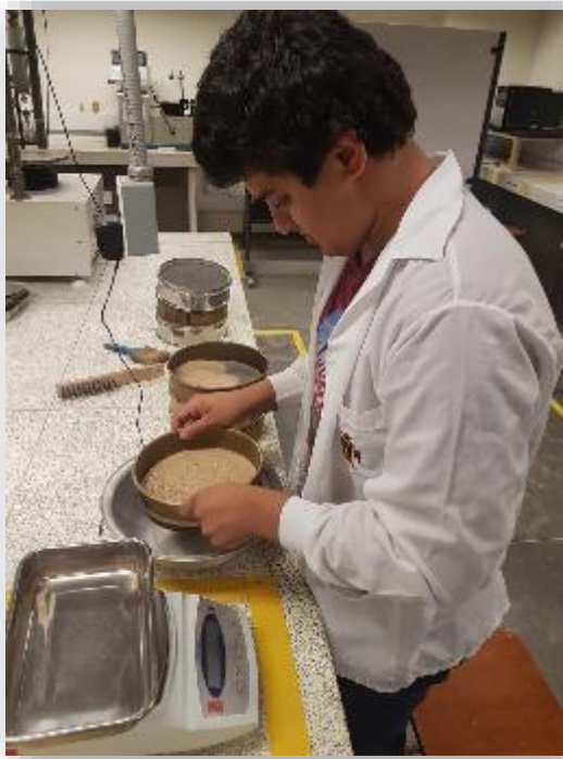
Granulometría por tamizado con lavado por la Malla No. 200
