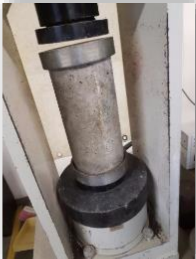
Ensayo de compresión al concreto
