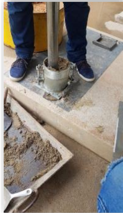
Ensayos de compactación tipo Proctor
