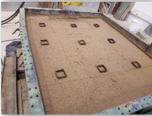
Ensayos de corte directo de muestras tomadas en sitio
