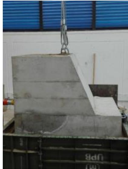
Montaje del muro sobre el suelo de fundación.
