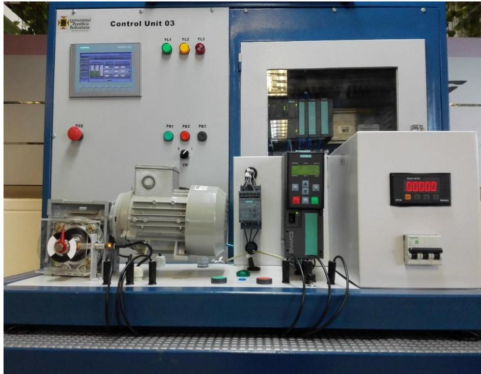
**Figura 1.** Unidad de control de velocidad y posición de un motor 1LA7 073- 4YA60. Fuente: Autor.
