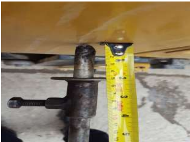
Imagen 9. Ajuste del espesor mediante el tornillo.
