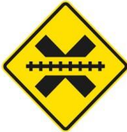
Figura 2. SP-52. Cruce a nivel con el ferrocarril
