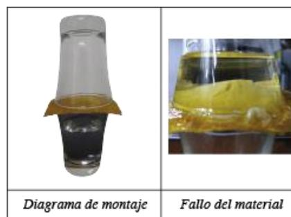
*Figura 3. Diagrama y evidencia del fallo del material en prueba de solubilidad.*
