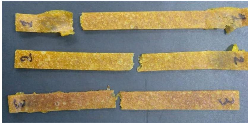
**Figura 5.** Muestra del fallo del material en la prueba de tracción
