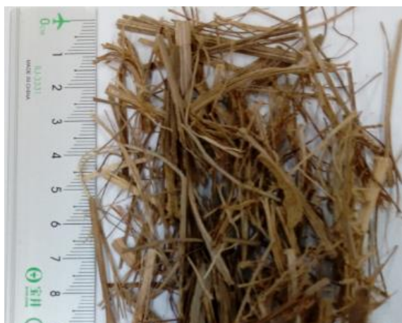
Figura 3. 5 Fibra extraída mediante el equipo de Steam Explosion
