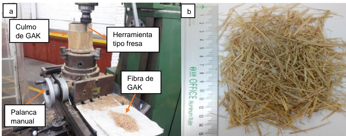
Figura 3. 1 Método de extracción. a) Montaje experimental. b) Fibra de GAK obtenida mediante extracción mecánica
