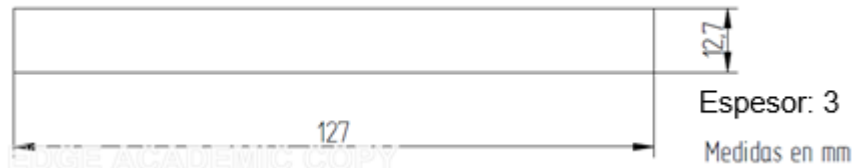
Figura 3. 18 Probeta utilizada en los ensayos de flexión a tres puntos
