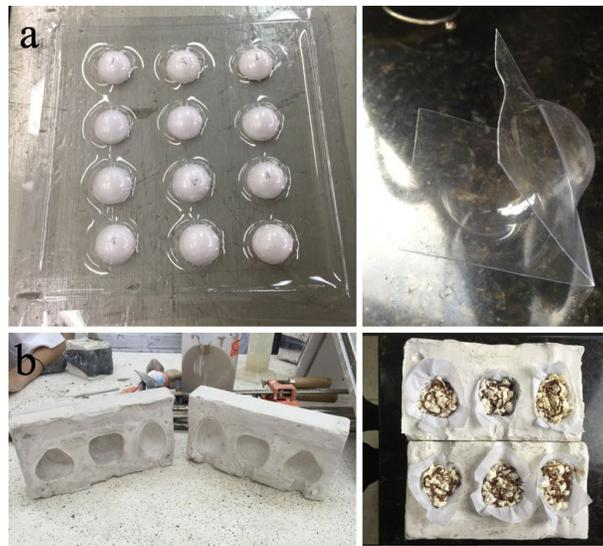
**Figura 3: a. Termoformado. b. Molde cerámico**
