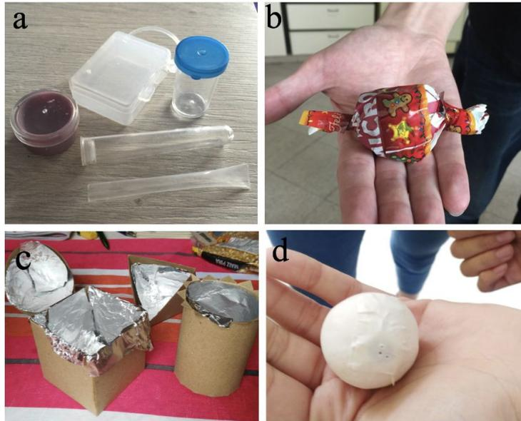
Figura 1: a. Moldes de Polipropileno, ABS y acrílico. b. Molde en papel parafinado. c. Moldes en cartón. d. Molde en cerámica.
