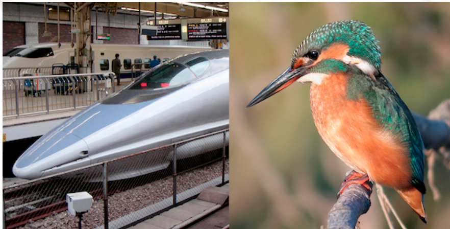
Figura 6: Tren bala Shinkansen de la empresa ferroviaria japonesa West Japan Railway Company es el tren más rápido del mundo (unos 320 kilómetros por hora). La parte delantera del tren bala se modela como referente en el largo y estrecho pico del pájaro Martin pescador. El diseño ahorró electricidad por ser tan aerodinámico y propicio un viaje mas silencioso. (Urgilez, 2015)
