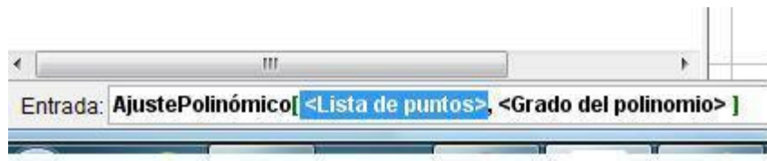
Figura 26. Ajuste del grado del polinomio en el campo de Entrada
