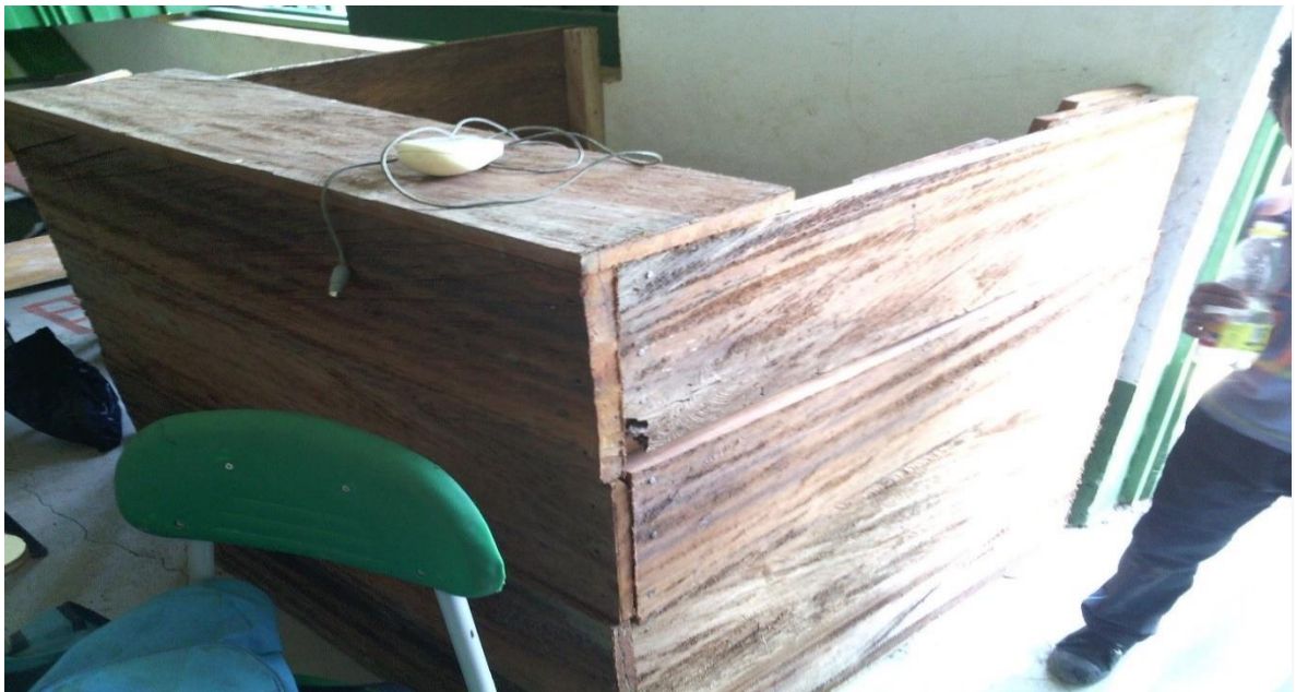
Figura 3. Construcción del cajón de madera para el molde de la paca.
