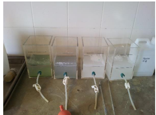
Imagen N°14: De izquierda a derecha adición peróxido de hidrógeno +sulfato de cobre y velocidad de agitación 120rpm, peróxido de hidrógeno +sulfato de cobre y velocidad de agitación 150rpm. ácido de caro y peróxido a una velocidad de agitación de 150rpm, y un tiempo cero
