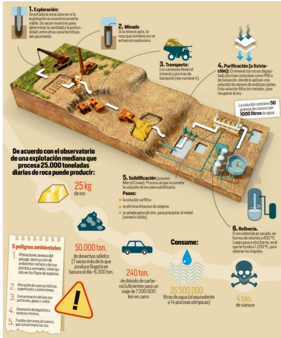
Figura 2. Funcionamiento de una mina a cielo abierto
