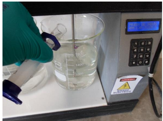
Imagen N°12: De izquierda a derecha adición acido de caro y peróxido, variando la velocidad de agitación ( pasando de 120rpm a 150rpm)
