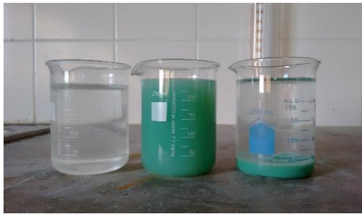
Imagen N°1: De izquierda a derecha, agua de BARREN sin detoxificar, agua de BARREN con peróxido de hidrógeno+ sulfato de cobre y agua detoxificada después de tres horas de reacción
