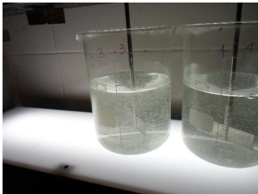
Imagen N°7: De izquierda a derecha adición de ácido de caro y peróxido de hidrógeno para un tiempo de dos horas
