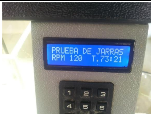
Imagen N°18: Condiciones o variables del corrido (tiempo de contacto y velocidad de agitación)
