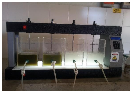
Imagen N°15: De izquierda a derecha adición peróxido de hidrógeno +sulfato de cobre y velocidad de agitación 120rpm, peróxido de hidrógeno +sulfato de cobre y velocidad de agitación 150rpm. ácido de caro y peróxido a una velocidad de agitación de 150rpm, y un tiempo de tres horas
