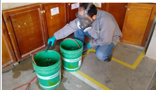
Imagen N°3: Adición de sulfato de cobre al agua de barren que ya contienen el peróxido de hidrógeno
