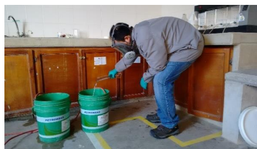
Imagen N°4: Duplicado del sistema (adición del peróxido de hidrógeno + sulfato de cobre)
