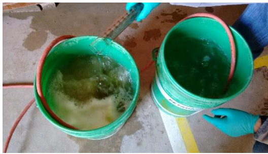
Imagen N°5: Reacción del agua de barren al realizar la adición del sulfato de cobre
