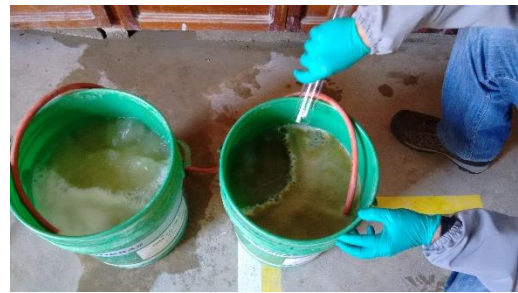
Imagen N°6: Reacción del agua de barren al realizar la adición del sulfato de cobre (duplicado)
