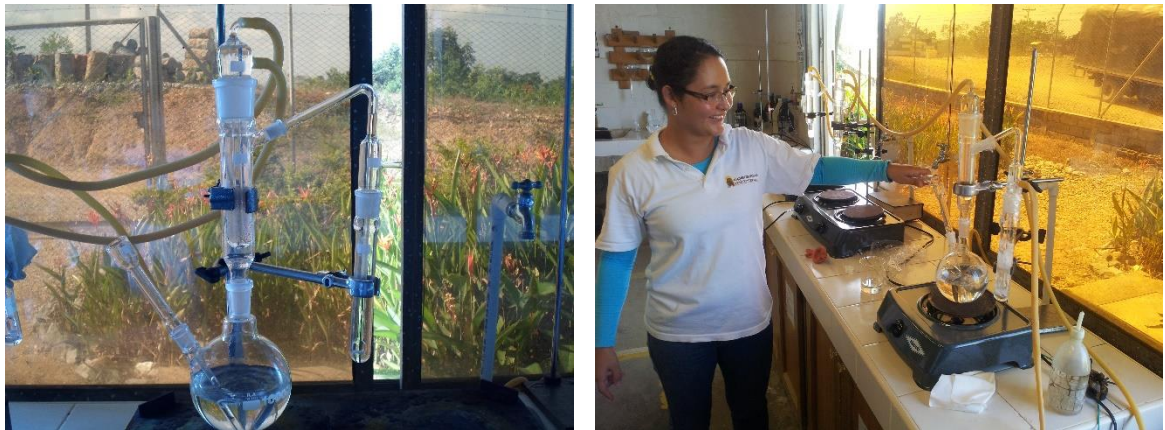
Figura 11. Montaje para pre tratamiento de la muestra y posterior cuantificación haciendo uso del electrodo selectivo o técnica volumétrica.
