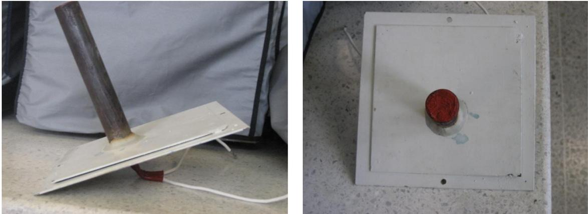
Para calcular el coeficiente de convección experimental para el tubo o cartucho se utiliza la fórmula (11), pero en este caso la temperatura de superficie calculada se reemplazó por la temperatura superficial experimental, posteriormente por conservación de calor se supone que toda la potencia disipada es transferida al aire, quedando en la ecuación (11) el coeficiente de convección como única incógnita, pero esta vez se llamará coeficiente de convección experimental.
