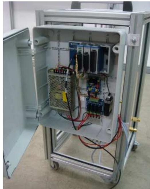
Figura 10. Tablero de conexiones Banco de Carga de Refrigerante
