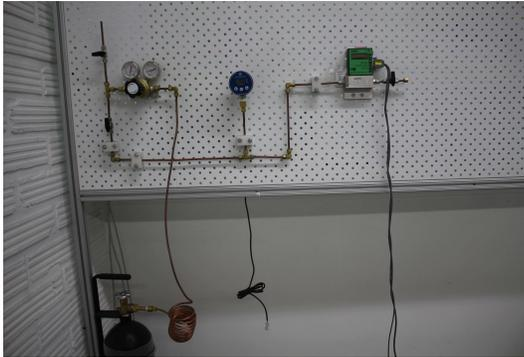
Figura 11. Banco de Caracterización de la Válvula
