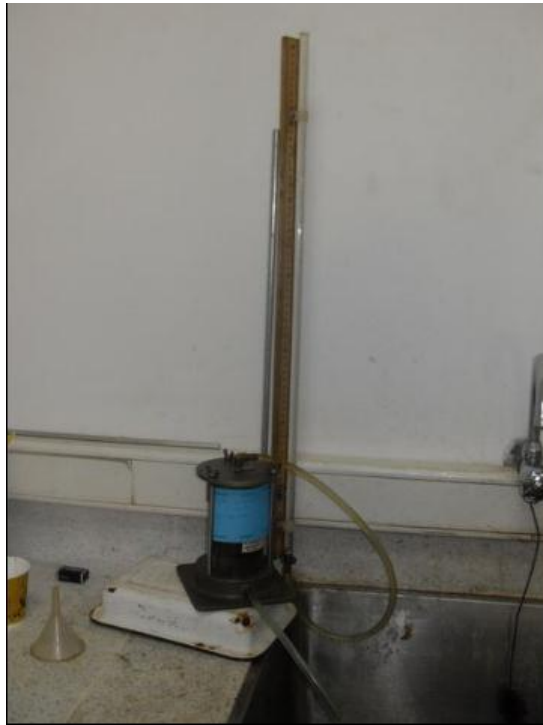
Figura 25 Ensayo de permeabilidad de los suelos
