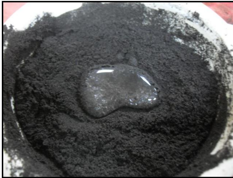
Figura 19 Muestra de la impermeabilidad adquirida por del suelo
