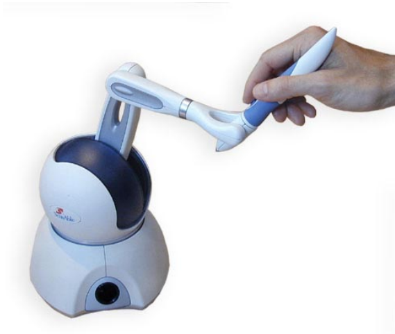
Figura 2. Interfaz Háptica PHAMToM®.
