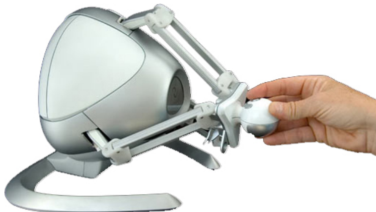
Figura 4. Interfaz Háptica Novint Falcon®.
