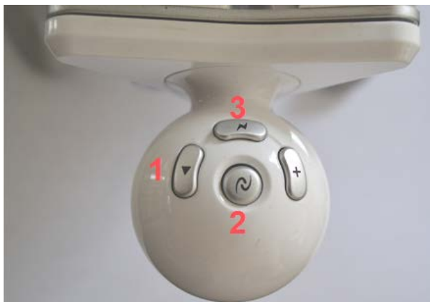
Figura 83. Botones Interfaz háptica Novint Falcon®.
