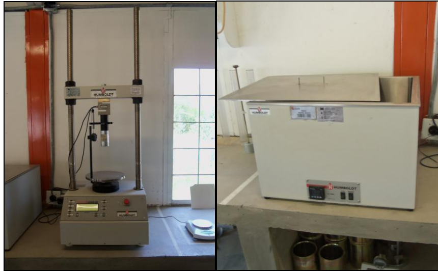
Fotografías No. 24 - 25. Prensa Marshall y Baño María Fuente: Consorcio Vial Helios – Los Autores
