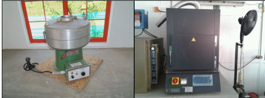
Fotografías No. 28 - 29. Centrífuga y Horno Extractor Fuente: Consorcio Vial Helios – Los Autores
