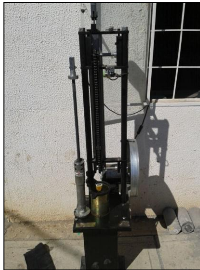
Fotografía No. 26. Martillo Neumático Marshall Fuente: Consorcio Vial Helios – Los Autores
