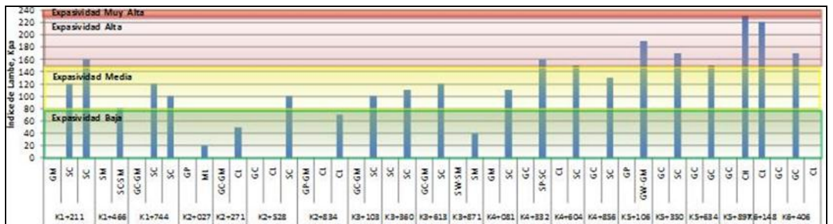
Figura No. 29. Índice Lambe Sector Geotécnico 1 Fuente: Consorcio Vial Helios – HMV Ingenieros – Los Autores
