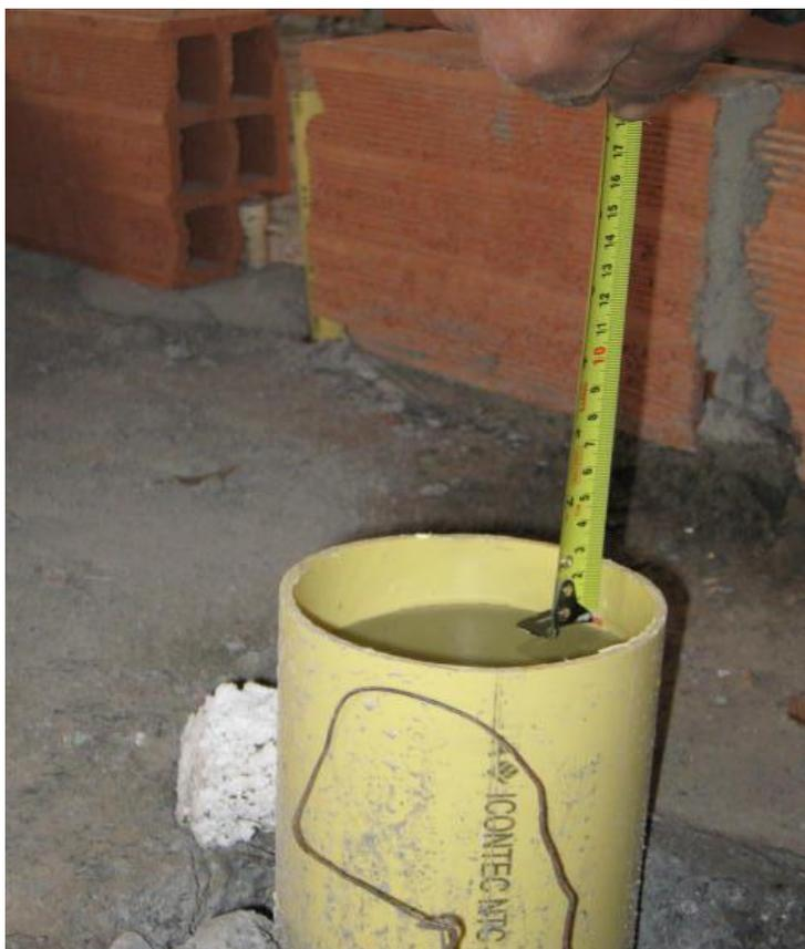
**Foto No. 6 Medida de nivel de Prueba de Estanqueidad<sup>18</sup>**
