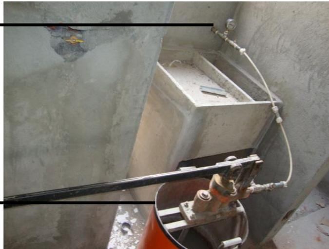
**Foto No. 8 Equipo Prueba Hidráulica**
