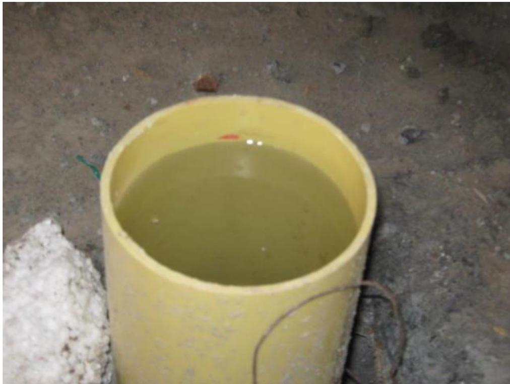
Foto No. 5 Llenado Prueba de Estanqueidad<sup>17</sup>
